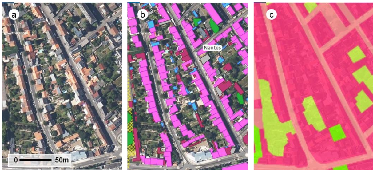
Figure 4. Perte de détail dans les bases de données d'occupation des sols dus aux seuils de sélection Exemple 2 sur un quartier de petites villas a/ Orthophotographie b / BDTopo tous thèmes c/ OSC GE © IGN
