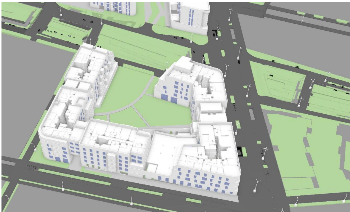
Figure 12. Identification grâce au CIM des surfaces imperméables, ici en gris © Urbanita Architecture, Agence Pietri, Atelier Alfonso Femia, Leclercq Associés, Atelier M3, Atelier 2/3/4, BASE, OTCI
