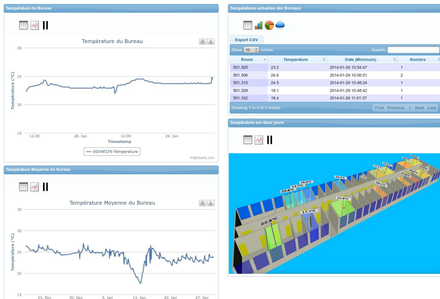
Figure 3. Tableau de bord : Projection 3D de la température sur les bureaux équipés de l'étage du bâtiment (bas droite) et courbes de température concernant un des bureaux du bâtiment (gauche), à partir des données collectées par la plateforme SoCQ4Home du LIRIS
