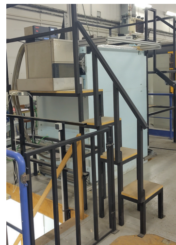
FIGURE 1. Schéma (a) et photo (b) de la cavité différentiellement chauffée
