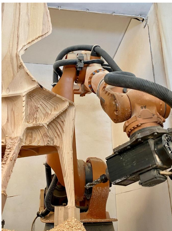
Figure 5. Cellule de découpe bois robotique « Habibi »
